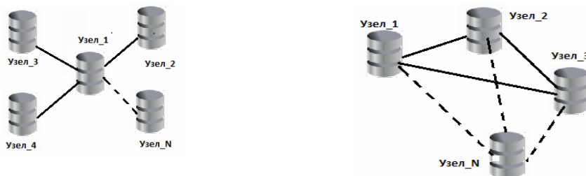
Рис. 1. Централизованная система (слева) и децентрализованная система (справа).
