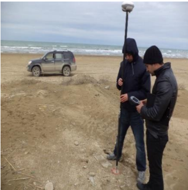
Şəkil 4-5. Torpaq reperlərindən ibarət sıxlaşdırılmış geodeziya şəbəkə məntəqələri.
