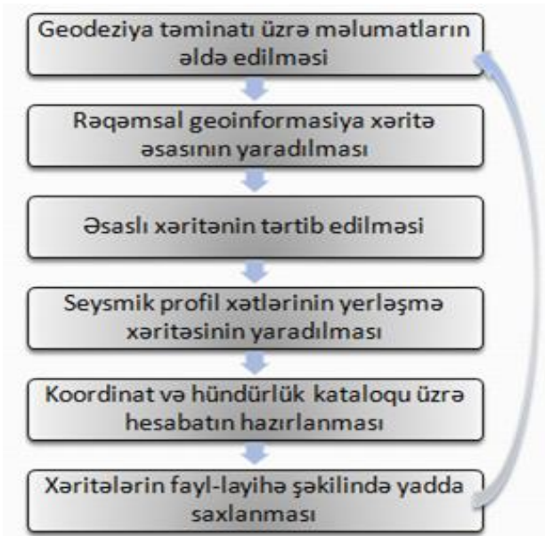
Şəkil 1. Geodeziya təminatına görə “çıxış” materiallarının formalaşması və tərtibatı üzrə ümumi texnoloji sxem.
