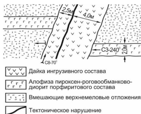
Рис. 4. Смещение дайкой интрузивных андезитов жильной апофизы пироксен-роговообманково-диорит порфиритового состава (зарисовка обнажения у слияния рек Казыханлычай и Тутхун).
