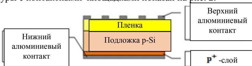
**Рис. 2.** Схематический вид гетероструктуры p-Si/n-ZnTeO
