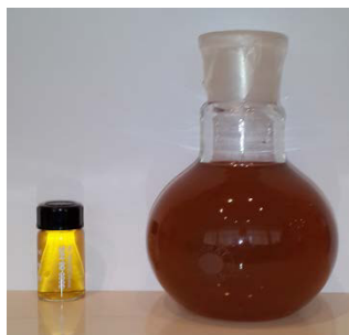
Şək.1. Nar yarpaqlarından hazırlanmış ekstrakt: sağda – 10^{-2} M qatılıqlı 1.0 ml \text{AgNO}_3 məhlulu əlavə olunmuş ekstrakt.
