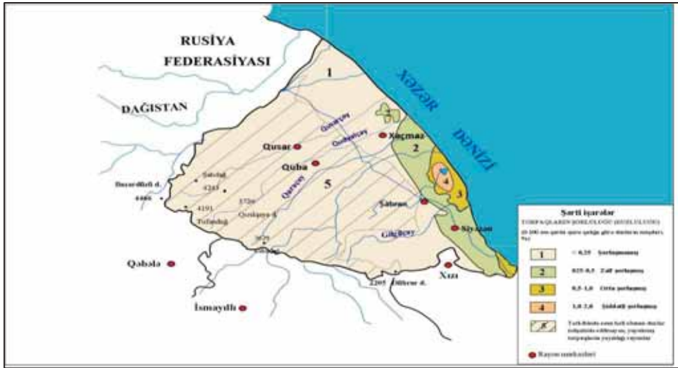
Şəkl. 1. Samur-Şabran zonasının aerasiya zonası süxurlarının şoranlaşma xəritəsi (M 1: 100 000, Azərbaycan Respublikası Kənd təsərrüfatı Nazirliyi yanında Meliorasiya və Su təsərrüfatı Agentliyinin Hidrogeoloji-meliorativ ekspedisiyasının faktiki materialları əsasında tərtib edilmişdir).
